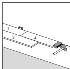
Méthode B : avec Uniclic®, vous pouvez également taper les panneaux les uns dans les autres, et ce, sans les soulever. Afin d'appliquer cette méthode, vous devez utiliser la cale de frappe Uniclic® spécifique. Les lames ne doivent pas être jointes étant tapées qu'une seule fois. Pour éviter d'endommager les panneaux, vous devez les taper petit à petit les uns dans les autres.
