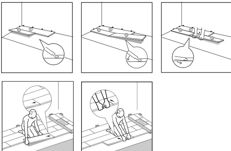
Uniclic® est un système unique, car vous pouvez poser les lames de deux façons différentes. Méthode A (angle-angle): premièrement, tournez le côté court de la lame à poser dans le côté court de la lame déjà posée à l'aide du principe de l'angle. Puis, levez la lame nouvellement posée à un angle de 20 à 30°. Cela va également soulever les lames précédemment posées dans la même rangée, car leurs côtés courts sont déjà connectés.
